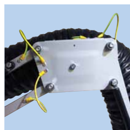
Led Mellemlader ved top knækket med aflastningskabler mellem konstruktionsdele.
