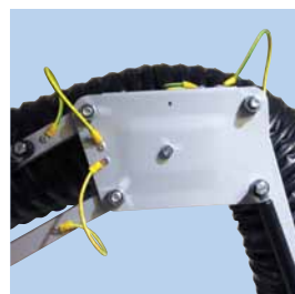
Gelenk Zwischenplatten am Top-Gelenk mit Entlastungskabel zwischen den Konstruktionsteilen.
