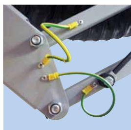
Bogen Boden des Bogens mit Erdungskabel-Verbindung an Parallelogramm.
