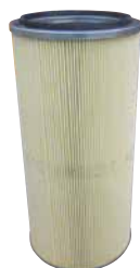
Patronenfilter Feinfiltration durch selbst-reinigenden Filterpatronen erhöht intervall zw. erfordernten Filtertauschen. (Normale Lebenszeit 2000-6000 Stunden.)
