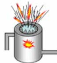
Entlastung: Durch Membran oder flammenfrei durch Hörbiger-Ventil
